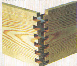
Ящичное соединение боковых стенок на прямых шипах.
