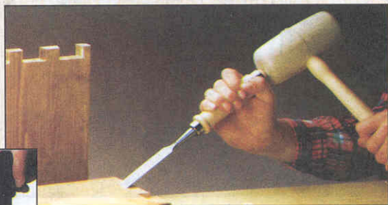
Ящичное соединение боковых стенок на прямых шипах.
